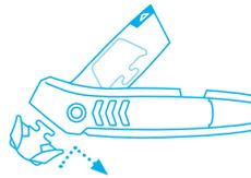
Positionnez la lame de rechange **parallèlement** à la partie inférieure du manche et insérez-la. Coulissez ensuite la tête de lame **vers la droite** jusqu'à la butée.
